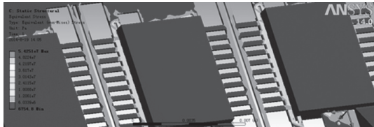
图 4 冷却阶段残余应力
